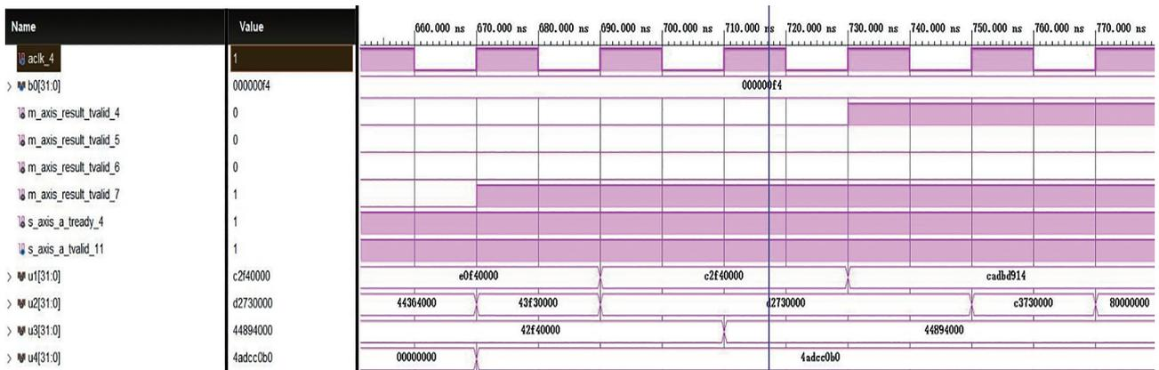
图 12 提出的插值系数模块硬件架构波形仿真
