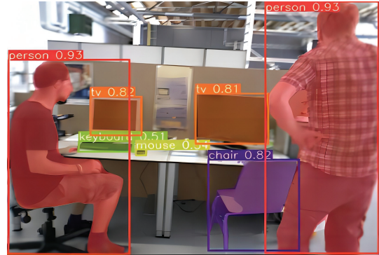
图 2 YOLOv8 检测与分割结果
