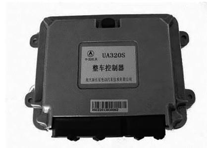
图 4 整车控制器
