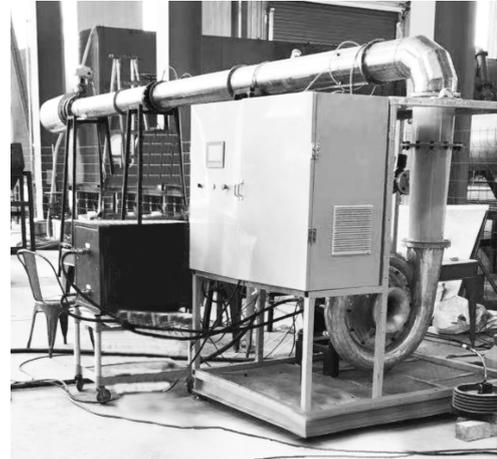
图 6 离心压缩机实验台
