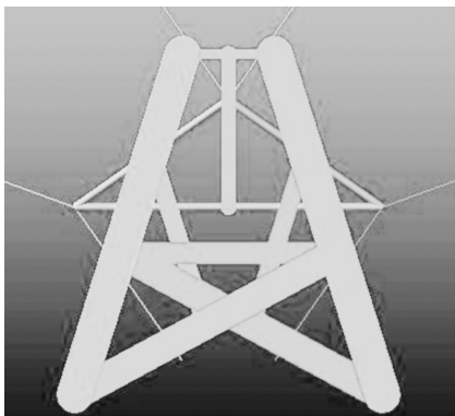
图 7 多顶点三角形刚性折纸图案的运动完成折叠
