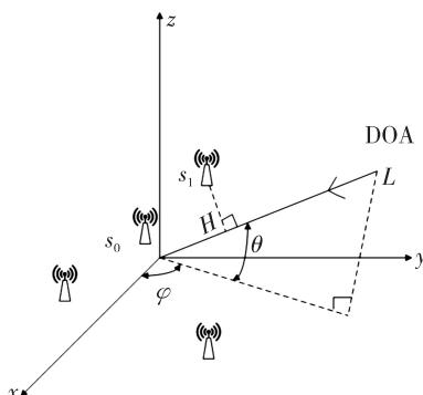
图1 传感器测向原理图
