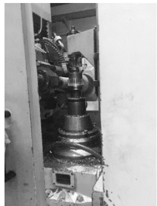
图 5 再制造与清洁化提升后的滚齿机
