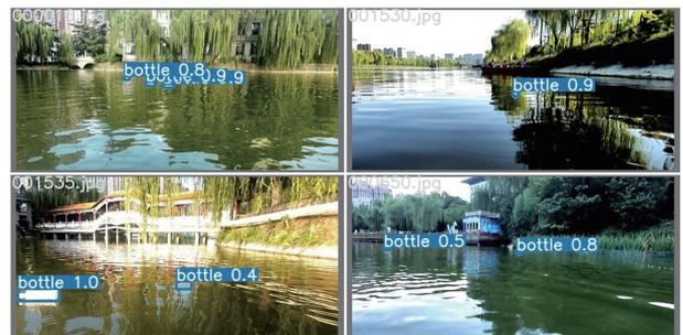
图 8 改进 YOLOv7 模型检测效果
