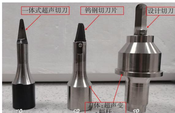
图 2 工程中不同形式的超声切刀
