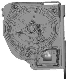
图 2 卷收器带感结构图
