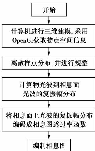
图 1 三维场景相息图生成流程图
