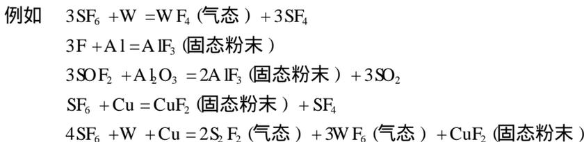
(5) 电器设备内的 SF<sub>6</sub>气体及分解物与绝缘材料反应而生成某些有毒产物。如与含有硅成分的环氧酚醛玻璃丝布板 (棒、管)等绝缘件;或以石英砂、玻璃作填料的环氧树脂浇注件、模压件、硅橡胶、硅脂等起化学作用,生成 SiF<sub>4</sub>、Si(CH<sub>3</sub>)<sub>2</sub>F<sub>2</sub>等产物。
